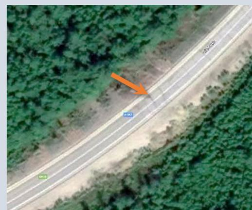
Сгущение трещин на дорожном полотне, свидетельствующее о деформациях насыпи
